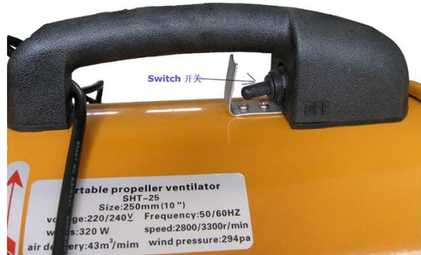
Вентилятор серии SHT предназначен для продувки колодцев (теплофикационных, канализационных, кабельных, водопроводных и др.), закрытых помещений перед проведением в них ремонтных и профилактических работ, тепловизионного контроля, осмотров, измерений и т.п., а также для организации приточной и вытяжной вентиляции с целью соблюдения требований безопасного выполнения вышеперечисленных работ. Вентилятор SHT может работать как в режиме приточной вентиляции, так и в режиме вытяжки.
